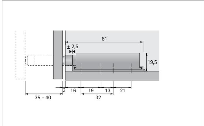
Einliegende Front: Bohrpositionen um Türdicke + 3 mm zurücksetzen
